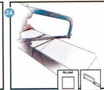
Alupfosten zurechtsägen. Schritt 14 für den zweiten Alupfosten wiederholen. Sägen Sie den zweiten Alupfosten auf die richtige Länge.
