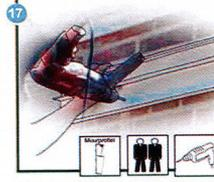
Bohren Sie die Löcher für die Schrauben im Mauerprofil vor.
