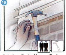
Befestigen Sie das Mauerprofil mit Schrauben an der Wand (2 Personen). Die Schrauben mit einem Hammer teilweise in die Befestigungslöcher schlagen und das letzte Stück der Schraube in die Wand drehen.
