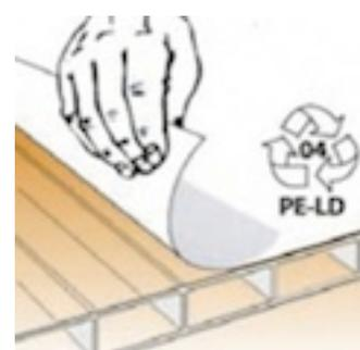
**SPARRENABSTÄNDE:** Bei Feuchtigkeit und Wärme dehnen sich Stegplatten durchschnittlich 6 mm je Meter Plattenlänge aus. Das notwendige Dehnungsspiel in der Breite wird bei Aluminium-Profilen mittels der Faustregel „Sparrenabstand = Plattenbreite + 25 mm“ ermittelt. Richtung Mauerwerk wird die Längsausdehnung über das Alu-Wandanschlussprofil verdeckt.
