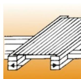
**STIRNSEITENVERSCHLUSS:** Um ein Verschmutzen der Hohlkammern durch Algen- oder Moosbildung zu verhindern, sind Stegplatten an den Stirnseiten dicht zu verschließen. An den oberen mit Reinaluminium-Klebeband und Abschlussprofil, an den unteren mit Filtaflo-Abdichtungsband und Tropfrandprofil. Letztgenannte sind so anzubringen, dass Kondenswasser ablaufen kann.
