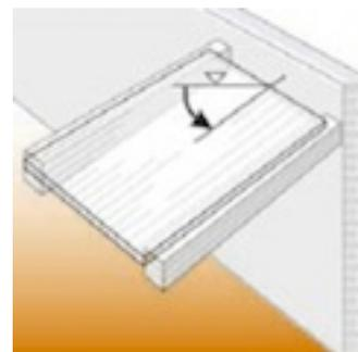
**KONDENSWASSER:** Da Acrylglas und Polycarbonat geringfügig gas- und dampfdurchlässig sind, kann witterungsbedingt feuchte Luft in die Stegplatten eindringen und die Hohlkammern beschlagen. Dies führt zur Bildung von Kondenswasser. Material und Funktion werden dadurch nicht beeinträchtigt. Beschlagen und Kondensat sind kein Reklamationsgrund!
