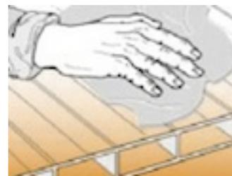
**REINIGUNG:** Zum Reinigen von Stegplatten genügen Wasser und ein sauberer Schwamm. Für stärkere Verschmutzungen sind haushaltsübliche Reinigungsmittel für Kunststoff geeignet. Keine scheuernden Materialien verwenden.
