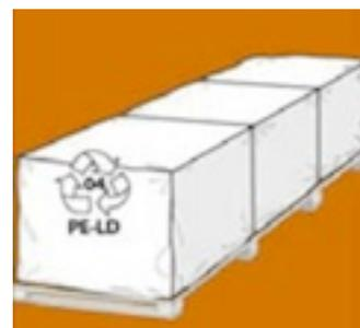
**LAGERUNG:** Der Untergrund muss absolut plan sein. Stegplatten möglichst in Innenräumen lagern. In Außenbereichen vor Regen und Sonneneinstrahlung schützen: damit keine Verformungen durch Hitzestau entstehen, Stegplatten mit einer weißen PE-Folie abdecken.
